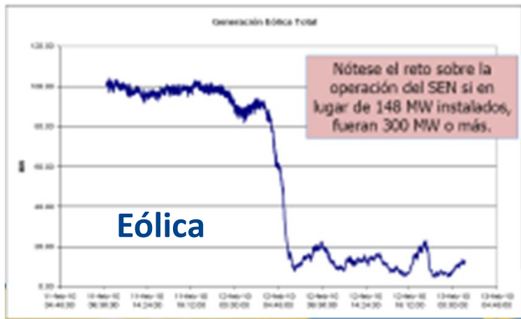
Cambio de potencia de la generación eólica mientras se da el aumento de demanda de la mañana
